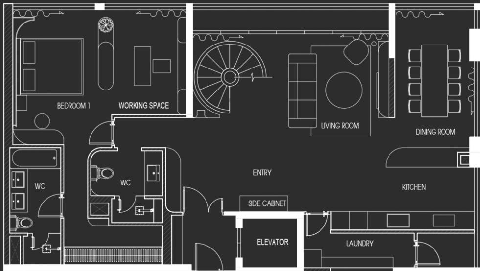
Với phương án ở tầng trệt, phần cầu thang vuông được cải tạo và thay thế bằng phương án cầu thang xoắn vừa tạo được đường nét mềm mại trong không gian, vừa là điểm nhấn và tận dụng được chiều cao ưu điểm của căn hộ duplex hiện có.
